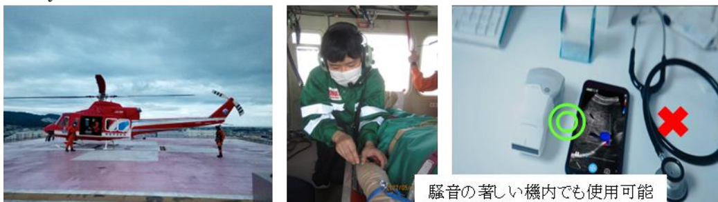
図2 プロジェクト2の実施要領。防災ヘリコプター機内でも、実際に使用可能な状況を確認した。航空機の無線機器等との干渉は無いと考えられた。
